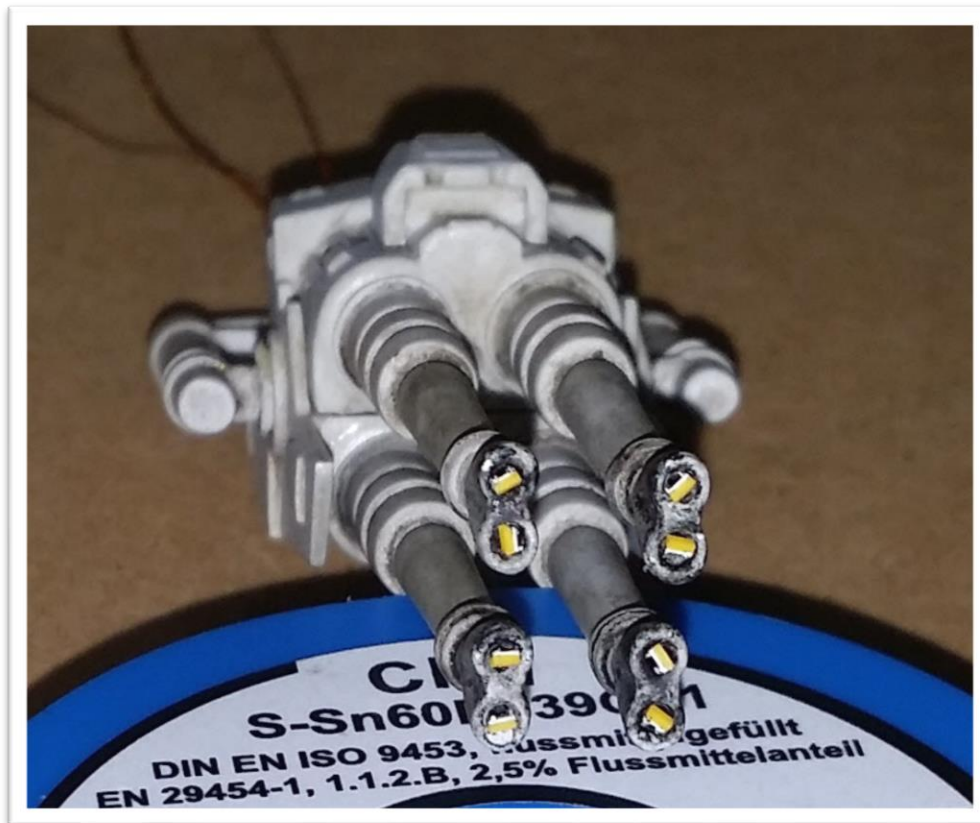
Figure 13 shapeways quadgun bestückt mit 0401 LEDs
